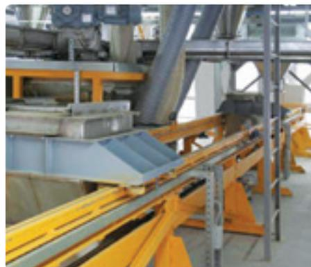
Один завод – один оператор. До 40 компонентов.  $Q = 3.5\text{т/ч}$ . Доза компонента от 0.1кг в автоматическом режиме. Транспортная система Shuttle Box
